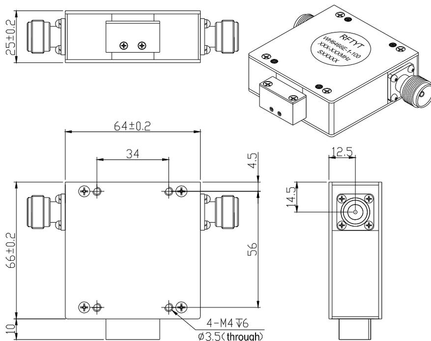
此图反射功率 100W，指标同表格，型号 TG6466EN-X-100/XXX-XXXMHz
